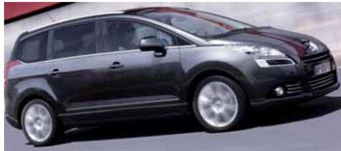
Benziner 1.6 Liter VTI (Variable Valve Lift and Timing injection), 120 PS (88 kW), 7,3 l/100 km, 169 g/km CO<sub>2</sub>, Fünfgang-Schaltgetriebe
