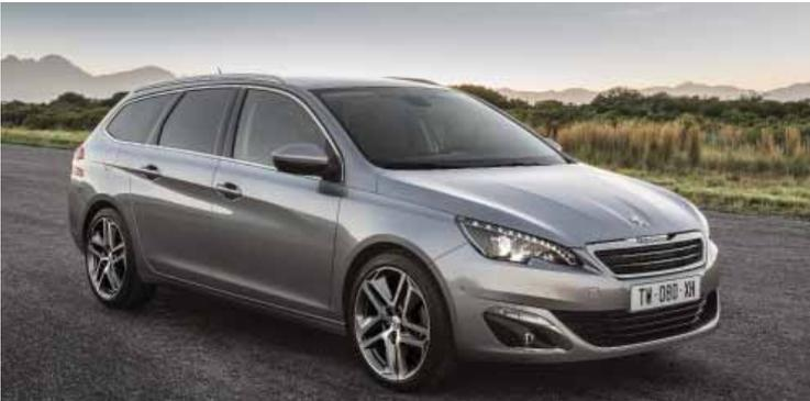
Der Peugeot 308 SW basiert auf der neuen modularen Plattform EMP2, die gegenüber dem Vorgänger eine Gewichtsparsnis von bis zu 140 Kilogramm verspricht. Auch deswegen hat der neue Peugeot 308 SW beim Raumgefühl deutlich zugelegt. Die geteilte Rückbank des Peugeot 308 SW kann per Fernbedienung vom Kofferraum aus umgelegt werden und eine komplett
