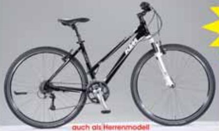
Alu-Rahmen, sperbare Federgabel Suntour SF10, Shimano XT 27 Gang, Ambrosi Feba Felgen, gefederte Sattelstütze, verstellbarer Vorbau und Hinterbauständer
