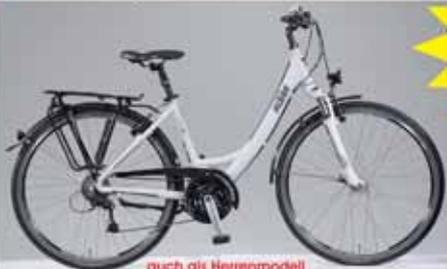
Alu-Rahmen, sperbare Federgabel Suntour NEX, Shimano Deore 24 Gang, Riga ZAC 2000 Felgen, gefederte Sattelstütze, verstellbarer Vorbau, Nabendynamo und kompl. STVO-Ausstattung
