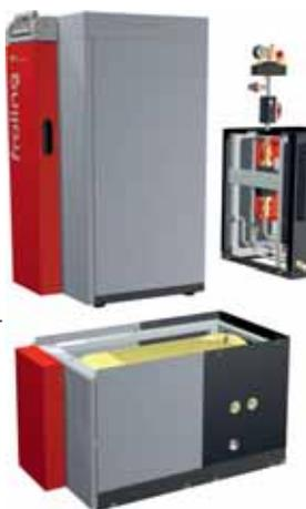
Das Hydraulikmodul ist flexibel zu bestücken und beinhaltet bis zu zwei Heizkreispumpen und zwei Heizkreismischer, ein Expansionsgefäß, ein Strangreguliertventil, eine Sicherheitsgruppe (mit Manometer, Schnellentlüfter und Sicherheitsventil) und eine optional erhältliche Boilerladegruppe.
