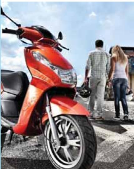
Der **Speedfight 3** ist ein Sportscooter der neuesten Generation. Ein leistungsstarker Zweitaktmotor mit wahlweise Luft- (4,1 PS) oder Wasserkühlung (5,2 PS) sorgt für den maximalen Vortrieb. Das sportlich abgestimmte Fahrwerk mit einer Upside Down Federgabel bei allen Modellen und einem Gasdruckfederbein in der wassergekühlten Version sorgt für ein kontrolliertes Fahrverhalten in jeder Situation.
